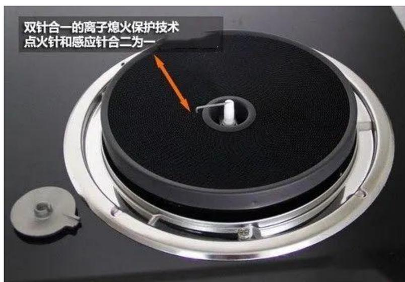
离子感应熄火保护装置主要通过旋动按钮放点打开燃气通道，然后完成点火，并进行持续供应；然后在火焰熄灭后，燃气供给通道中断，从而关闭阀门。燃气灶既方便了我们的生活也带着一定的危险性，安装有离子感应熄火保护装置的燃气灶通常为红外线灶，技术更为成熟，而且没有老化现象，但成本略高于热电偶熄火保护装置。而且，离子感应熄火保护装置虽然敏捷，但是即使是自然风稍将火焰吹离感应针，但并未使燃气灶熄火，感应装置同样会做出反应关闭气源，这样就必须重新点火。
