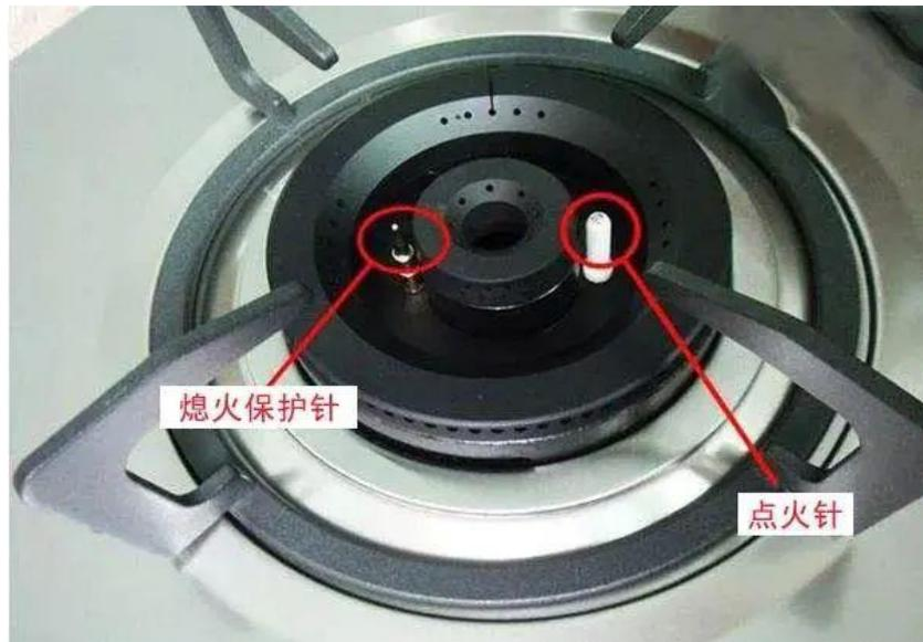
热电偶熄火保护装置的特点为阀门的开启主要靠旋钮带动，安全有效，成功率非常高。但是缺点也很明显，热电偶容易老化，燃气灶使用时间久了，热电偶很有可能老化而造成并未达到限定温差火就熄灭了，频繁熄火很容易影响使用。而且，热电偶熄火保护装置的反应时间过长，技术敏感性差，还是会有意外发生。
